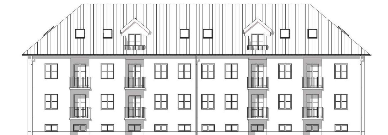
Vestfacade med nye altaner - samtlige blokke
